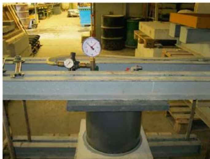
Bild A2: Dichtigkeitsprüfung
